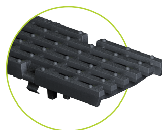
LANGSTAVET STØPEJERNRIST bredde på/ -i mellom staver 29/13, klasse C 250 – D 400
