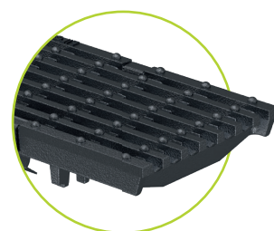
LANGSTAVET STØPEJERNRIST bredde på/ -i mellom staver: 28/9, klasse D 400
