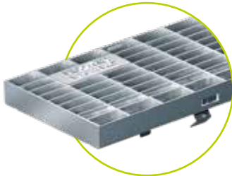
2 GITERRIST MW 30/10 klasse A 15 – C 250 Galvanisert stål.
