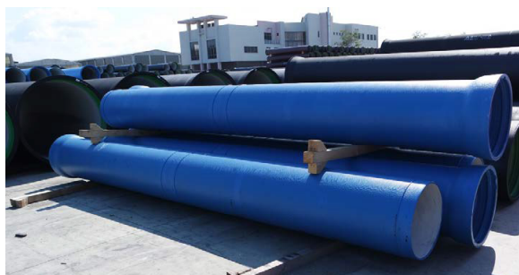
Rør med 2 ekstra sveiselarver hver
