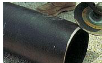
Figur 3: Avrunding av skarp kant med vinkelssliper og kontrollmåling av vinkelen.
